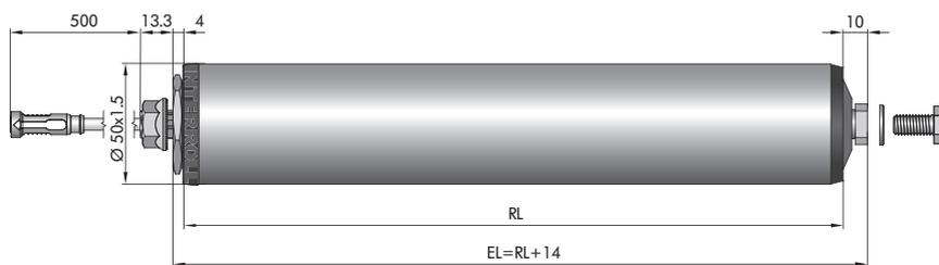
M8 内螺纹，带沟槽
