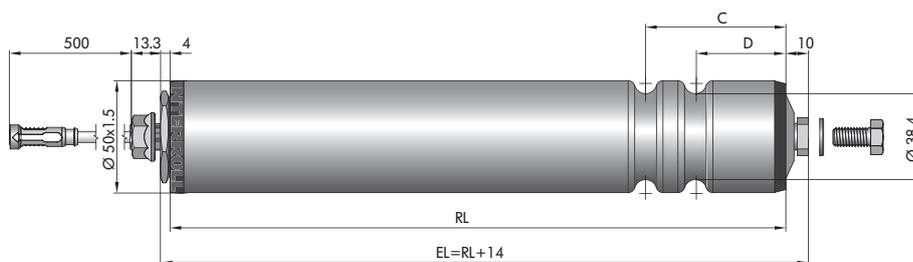
带 M8 内螺纹的 PolyVee 驱动头
