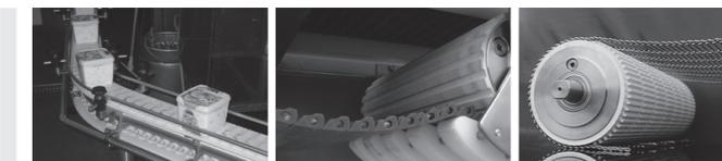
Modulare Kunststoffbänder, thermoplastische Bänder sowie Bänder aus Stahlgeflecht oder Draht werden formschlüssig, d. h. ohne Bandspannung, angetrieben. Da das Band kaum direkten Kontakt mit der Trommel hat, ist die Wärmeableitung in diesen Anwendungen weniger effektiv. Für solche Anwendungen empfehlen wir die Verwendung eines effizienten Asynchron-Trommelmotors mit hohem Wirkungsgrad oder den Einsatz eines Synchron-Trommelmotors.
