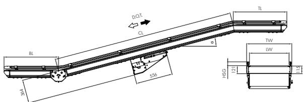
Abb.: Interroll Gurtförderer BM 8434 Mittenantrieb + Bogen oben + Vorlauf
