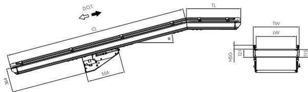
Abb.: Interroll Gurtförderer BM 8432 Mittenantrieb + Bogen oben
