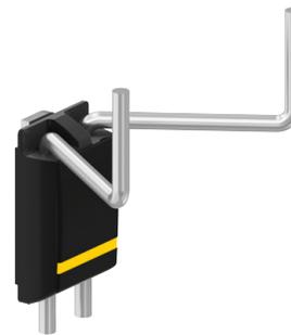
Am flexiblen Universalträger werden Seitenführungen, Sensoren, Reflektoren und andere Anbauteile wie Scanner etc. befestigt. Flexible Universalträger werden seitlich am Profil angebracht. Einer dieser Halter kann je zwei flexible Universalträger-Bügel aufnehmen.
