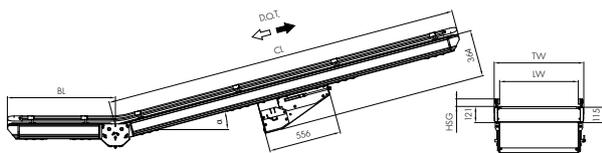
Abb.: Interroll Gurtförderer BM 8433 Mittenantrieb + Vorlauf
