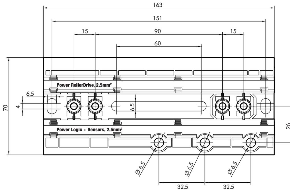
Um den Magnetschlüssel platzieren zu können, muss der Abstand von der Oberkante der MultiControl zu benachbarten Bauteilen mindestens 10 mm betragen.
