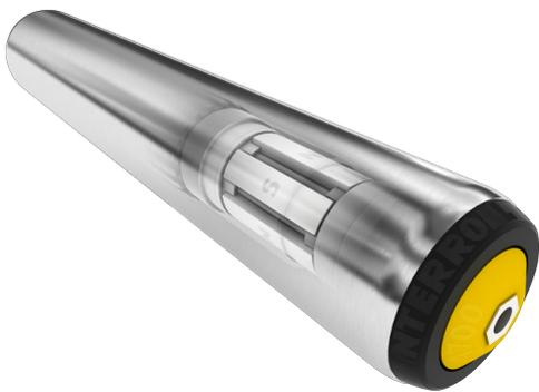
Der Magnetische Geschwindigkeitsregler MSC 50 ist ein rein mechanischer Geschwindigkeitsregler, der für eine kontrollierte, langsame Geschwindigkeit auf Gefällebahnen mit Fördergutgewichten von 0,5 kg (1 lbs) bis maximal 35 kg (77 lbs) sorgt. Der Magnetgeschwindigkeitsregler arbeitet getriebelos und erlaubt daher den Anlauf von Behältern mit sehr leichten Gewichten. Die schweren Behälter laufen dank ständig hoher Bremsleistung mit kontrollierter Geschwindigkeit ab.
