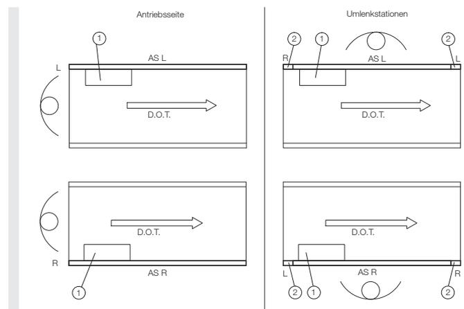
Abb.: Antriebsseite rechts (R) und links (L) und Umlenkeinheiten
