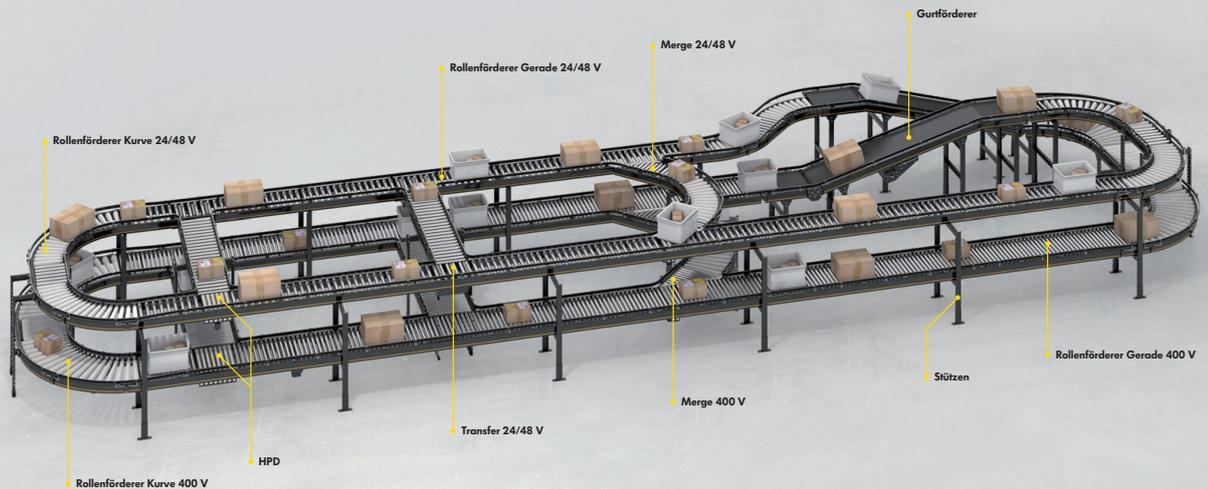
Für den Kühlbereich, der meistens zwischen 0 und +5 °C liegt, kommen zusätzlich auch Gurttförderer zum Einsatz. Somit ist es möglich, eine durchgängige Materialflusslösung bei verschiedenen Umgebungstemperaturen modular und flexibel einzusetzen.
