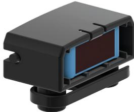
Mit Sensoren werden Fördergüter auf den Förderern detektiert und ihre Position bestimmt. Es werden Reflex-Lichtschränke verwendet, die einen Reflektor-Spiegel (Reflektor) gegenüber der Lichtschranke benötigen, um den Lichtstrahl zurückzuwerfen. Das Sensorkit besteht aus dem Sensor und dem passenden Kunststoffgehäuse inklusive Befestigungsclip. Das Gehäuse kann direkt auf der Rollenbahn oder einem Universalträger befestigt werden.
