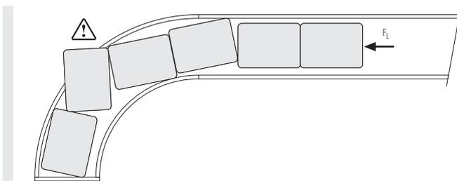
Der Staudruck in einer Kurve kann durch folgende Maßnahme reduziert werden:
