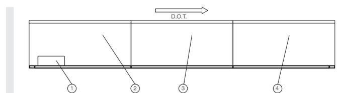
Abb.: Beispiel einer Förderlinie aus drei Modulen
